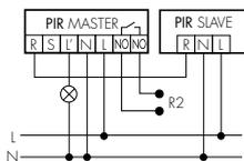
Aumento del campo d'azione con l'impiego con uno o più apparecchi Slave. L'apparecchio Master deve essere sempre montato nella posizione in cui la luce del giorno è minima.
