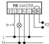
Premendo brevemente il tasto si può accendere o spegnere l'illuminazione a seconda dei bisogni (Attenzione: i pulsanti luminosi senza collegamento al conduttore neutro non possono essere gestiti).
