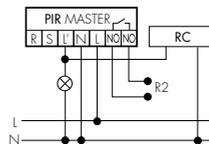
Per la commutazione con lampade fluorescenti, trasformatori, ecc. è eventualmente necessario l'uso di un circuito RC.
